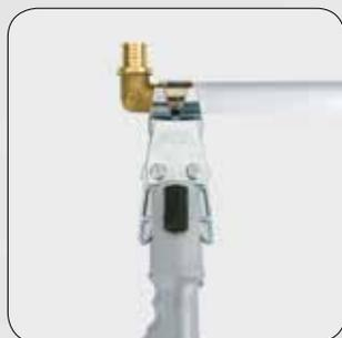
Надвинуть гильзу при помощи инструмента.
